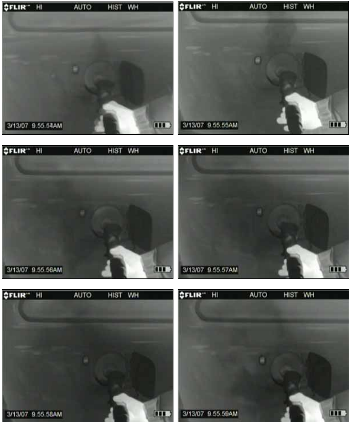
Figur 36 Exempel på bildsekvens från GasFindIR-kameran under ett tankningstillfälle utan gasåterföringssystemet aktiverat. Emissionen av bränsleångor syns som grå-svart rök på bilderna. (utplockade stillbilder från 6 sekunder av videosekvensen).
