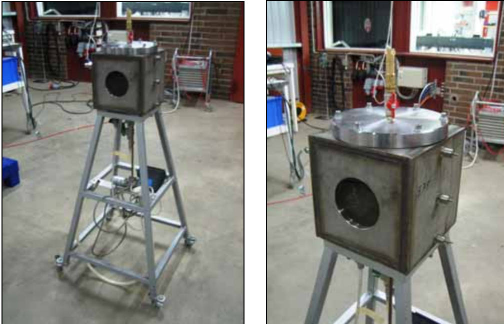
Figur 8 Explosionskammare ("bomb") med volymen 8 dm 3 som användes vid explosionsförsöken.
