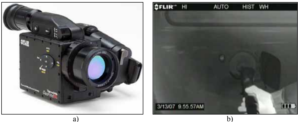
Figur 34 a) IR-kameran GasFindIR från FLIR Systems AB som användes för att få en grov bild av gasemissionerna runt påfyllningsöppningen vid tankning. b) Ett exempel på den typ av bild som kameran visar där det mörkgrå området till vänster om påfyllningsöppningen indikerar bränsleångor.
