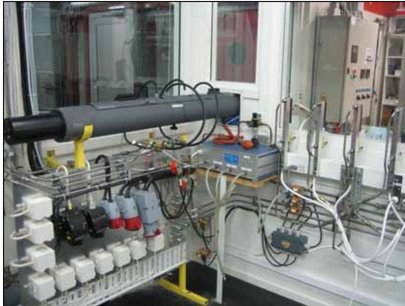
Figur 7 Laborieutrustning för blandning och mätning av provgasblandningar.
